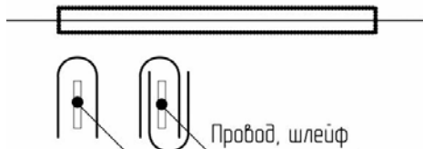
Использование дополнительных гибких кожухов для защиты шлейфов и спусков проводов
